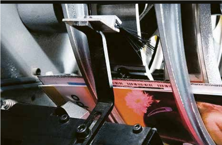
Sammelheft-Systeme und Softcover-Produktion: Asir 3, Bild- und Barcode-Kontrolle
