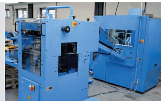
Der Dreischneider Granit (rechts), den Finishline vor einem Buchzählstapler Uno (links) einsetzt, überzeugt dank innovativer SmartPress-Technologie mit hervorragender, konstanter Schnittqualität.
