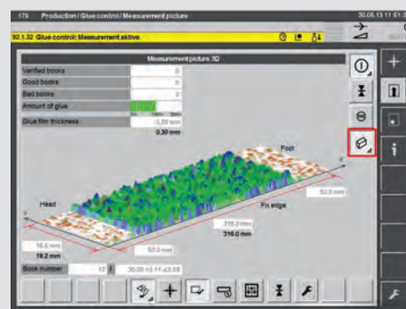
Beim AMS-System wird die Klebstoffdicke am Monitor mit einer übersichtlichen Grafik dargestellt, und die Klebstoffmenge lässt sich mit Feinjustierungen manuell anpassen.
