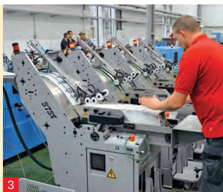
2 Der neue Sammelhefter Primera 160 produziert bei Fr. Ant. Niedermayr regelmässig am Limit von 16 000 Takten pro Stunde.
