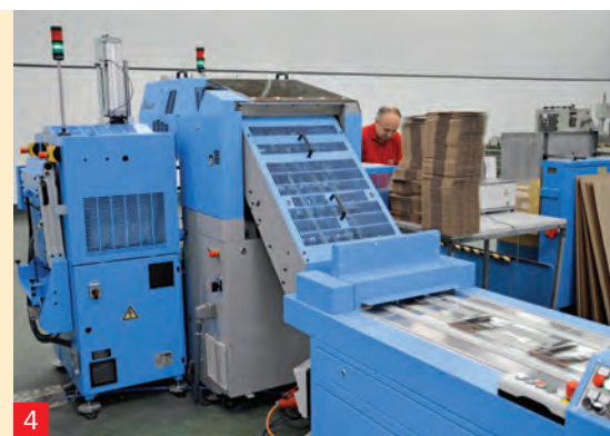
4 Einen wesentlichen Anteil an der hohen Produktivität der neuen Primera 160-Linie hat auch der leistungsstarke Kreuzleger Robusto, der für perfekte kreuz- oder lagengelegte Pakete sorgt.
